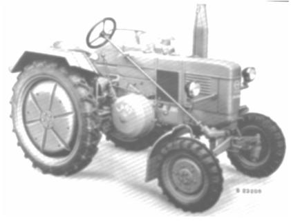
Glühkopfmotor war. Die Besonderheit daran war, dass der Motor mit einer Zündanlage als Benzinmotor gestartet wurde, und nach einiger Zeit als Dieselmotor weiterlief. Daher kommt der Name -Halbdiesel-
