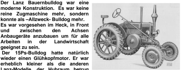
Die Kühlung funktionierte (wie auch bei allen Folgemodellen) nach den Thermosyphonsystem, das heißt der Motor hatte keine Wasserpumpe. Im wärmsten Bereich am Zylinderkopf stieg das erwärmte (leichte) Wasser über einen großen Kanal noch oben um dann in einem automatischen Kreislauf in den Kühlerwaben abzukühlen und schweres nach unten in den Zylinder zu strömen. Dann begann der Kreislauf von vorne.
