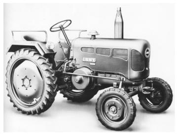
seitdem (unter den Oldtimerfreunden) Volldiesel. Der Benzintank und die Zündkerze waren verschwunden. Der Motor konnte mit Glühkerze und Dieselkraftstoff schnell gestartet werden.
